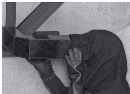
Bild 11: Bewertung der Schweißnaht mit einem Leuchtschirm
