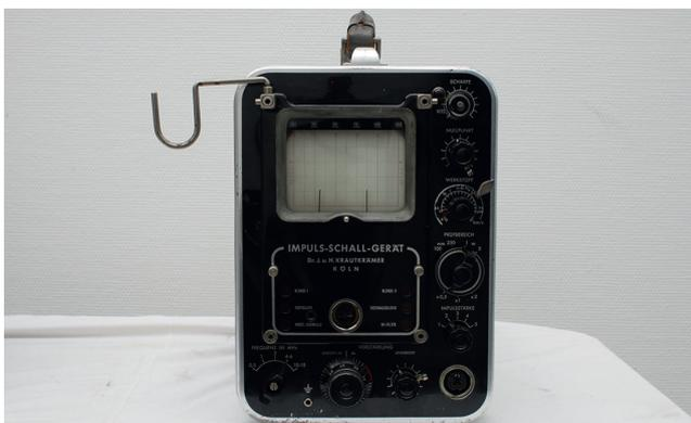
Bild 29: Ultraschallprüfgerät USIP 10
