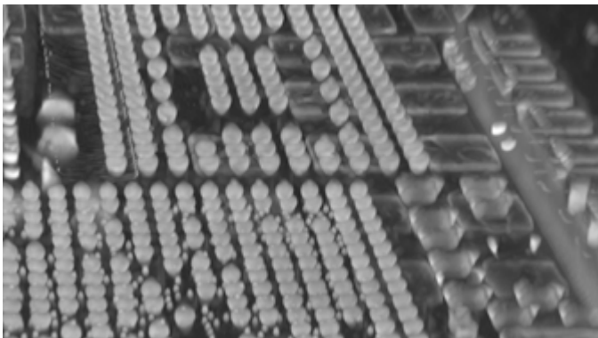
Abbildung 20: Schrägsicht eines Prüfobjekts (LGA)
