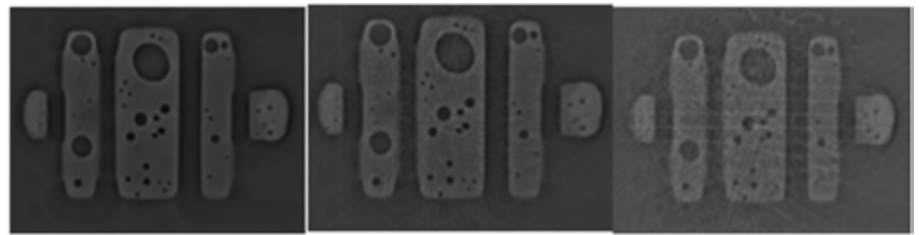
Abbildung 31: Schnittbilder aus Rekonstruktionen mit 200 Projektionen, 30 Projektionen und 10 Projektionen (von links nach rechts)
