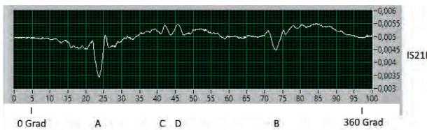
Bild 9: Umfangsscan durch die Schweißnaht hindurch. Dargestellt ist der unkalibrierte Transmissionsparameter  $|S_{21}|$  über dem Drehwinkel. A, B - Durchgangsbohrungen mit Durchmessern von 5 mm bzw. 3 mm. C, D - Sacklochbohrungen von innen mit einem Durchmesser von 3 mm und Tiefen von etwa 2 mm bzw. 4 mm.
