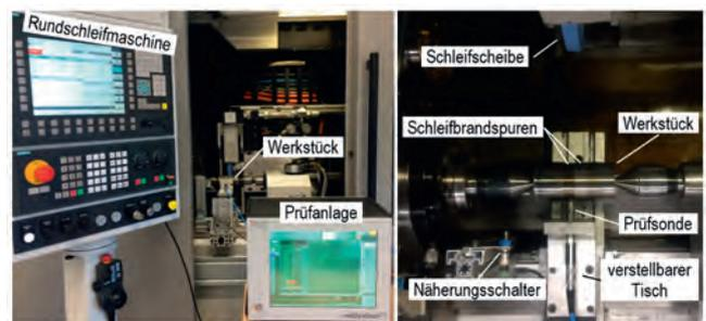
Abb. 2 Schleifmaschine (EMAG HG 204) zur Herstellung von Werkstücken mit Schleifbrand für die Entwicklung des Sensors und zur Integration der entwickelten Sensorkombination („Sensorfusion“) für die Echtzeitüberwachung des Schleifprozesses.
