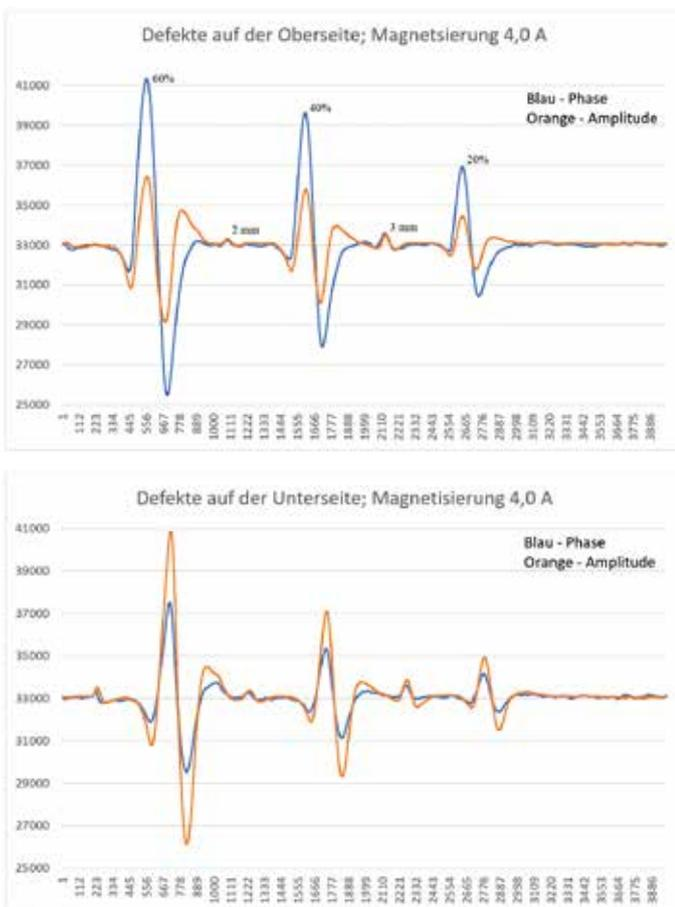
Abbildung 12: Ergebnisse der modifizierten Wirbelstromtechnik.
