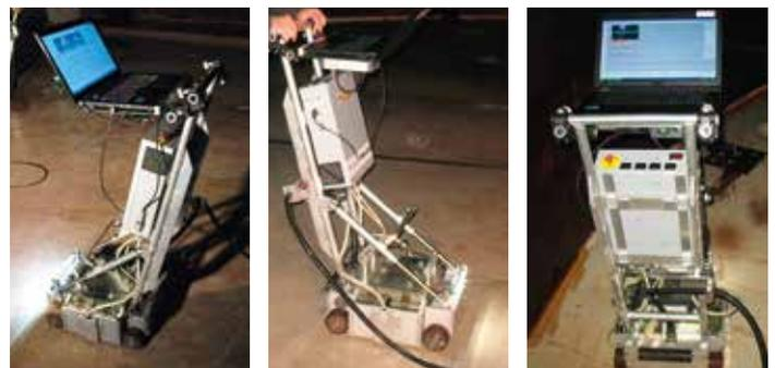
Abbildung 1: FIT-Tankbodenprüfgeräte im Einsatz.
