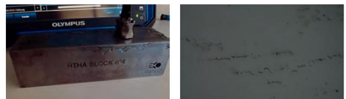
Bild 15: Testblock mit Prüfkopf und Schlibbild der Anzeigen
