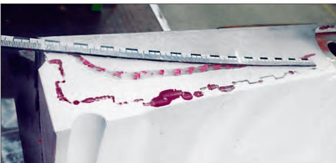
Abbildung 8: Eindringprüfung der Lagerschale 2: umlaufende lineare Anzeige im Bereich der Bindung
