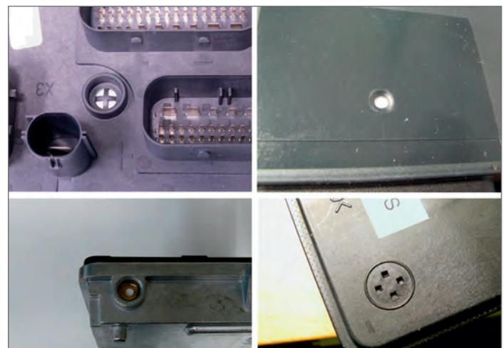
Bild 2: Prüfteile mit integrierten Druckausgleichselementen
