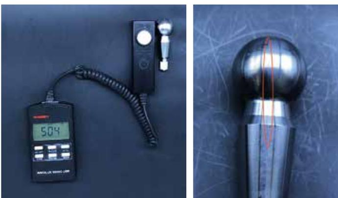
Abbildung 2 Kugelzapfen mit rissartiger Anzeige bei 504 Lx, rechts Detailaufnahme Anzeigebereich
