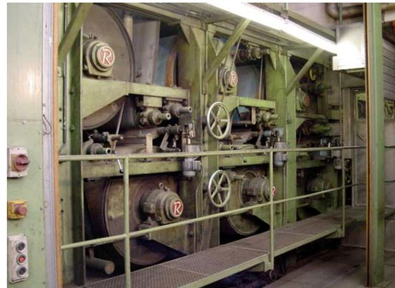
**Abb. 10: Trockenzylinder in einer Trockengruppe einer Papiermaschine**
