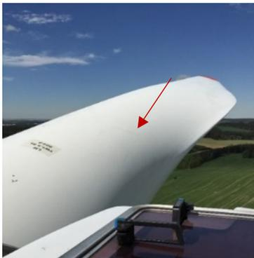
**Abb. 37: Reparaturstelle am Rotorblatt**
