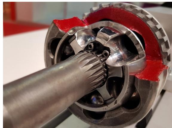
**Abb. 31: Antriebswelle mit Sprengring**
