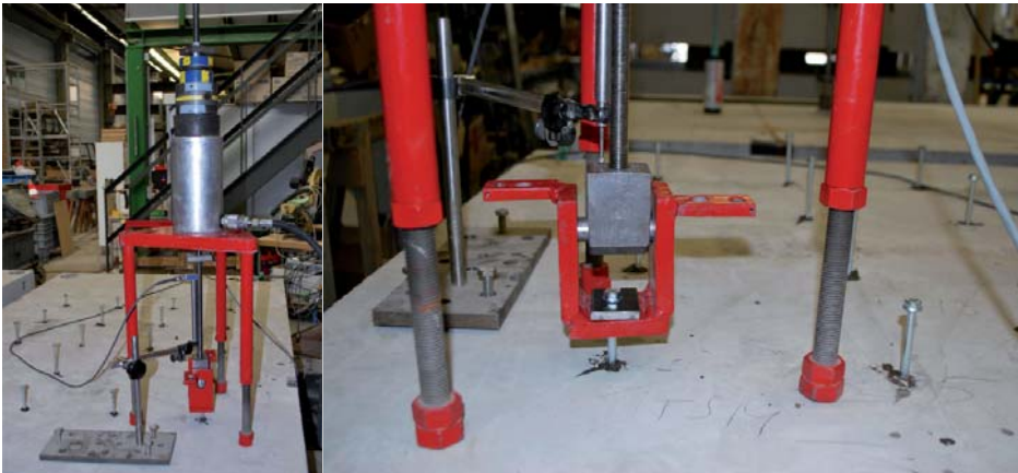
Schraubankerversuch; Versuchsaufbau (links) und Detail (rechts)
