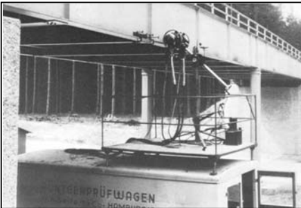
Bild 57: Der Röntgenprüfwagen dient als Arbeitsbühne bei einer Brückenprüfung
