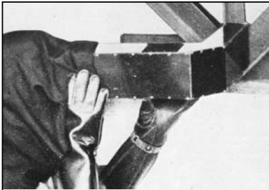
Bild 18: Friedrich Wulff mit dem „Sichtgerät“ bei der Durchleuchtungsprüfung aus Bild 17
