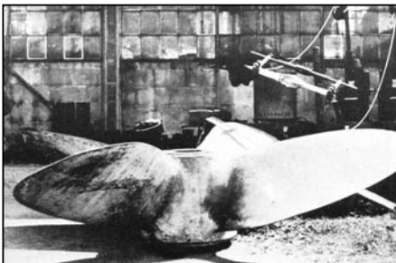
Bild 32: Durchstrahlungsprüfung an einer reparierten Bronze-Schiffsschraube
