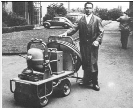
Bild 80: Heinz Heidenreich, MPI Düsseldorf, mit einem leistungsfähigen Kobalt-Strahler, Behälter-Bauart RTD Rotterdam, Gewicht etwa 0,5 t
