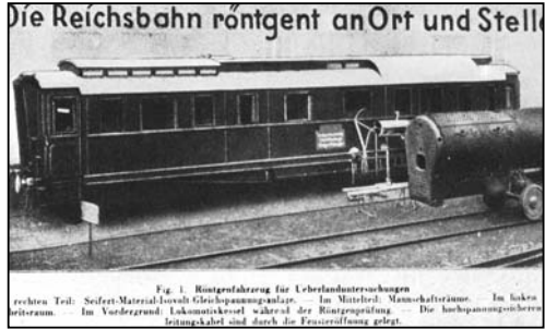
Bild 20: Illustration zu einem Pressebericht über den Einsatz des Röntgen-Messwagens der Reichsbahn
