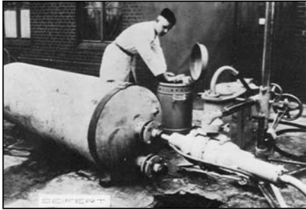
Bild 50: Dr. Trost prüft eine Behälter-Rundnaht mit der Rundstrahl-Hohlenodenröhre
