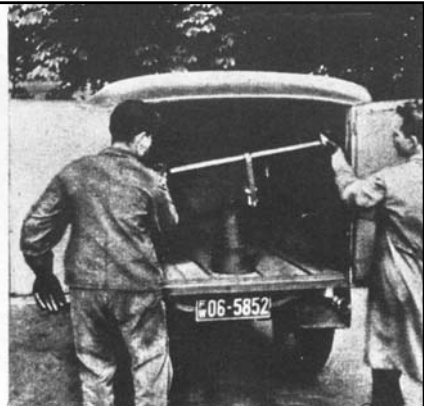
Bild 70: Der Kobalt 60-Arbeitsbehälter wird dem Transportbehälter im PKW entnommen
