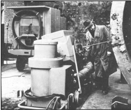
Bild 83: Das 15 MeV-Siemens-Betatron bei Mannesmann in Huckingen, betrieben vom MPI. Am Gerät Heinz Heidenreich beim Einrichten einer Aufnahme
