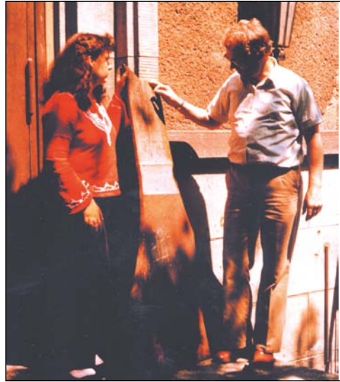
Der Autor zusammen mit Frl. Böhme (jetzt Dr. Ahrens) vor der größten in der DDR jemals geprüften Zug-Druck-Probe. Zum Nachweis dafür, daß die Schweißnähte des Sicherheitscontainments eines WWR 1000 bei einem Reaktorunfall nicht reißen würden, wurde eine begleitende Schallemissionsprüfung durchgeführt
